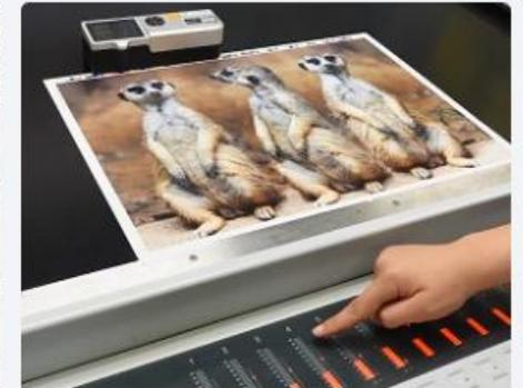
Vollton-Schichtdickenmessung (Dichte) & Volltonmessung LAB (Farbton) mit einem Spektralfotometer (Premium)
